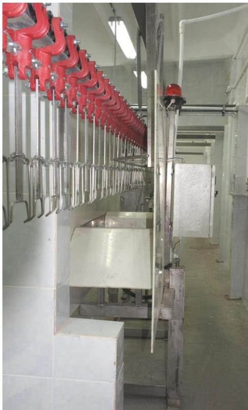
Несущей конструкцией аппарата является станина, на которой закреплена ванна с водой. Для предотвращения поражения человека электрическим током ванна с водой по обе стороны аппарата ограждена диэлектрическими листами. Птица, попадая головой в ванну с водой, замыкает электрическую цепь, подвергаясь при этом воздействию электрического тока. Выходя из ванны, птица находится в оглушенном состоянии. К ванне подводится водопроводная вода. Поплавковый механизм поддерживает заданный уровень воды.
