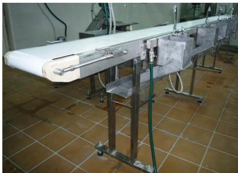
Регулировка натяжения ленты осуществляется болтами натяжного механизма. При необходимости санитарной обработки поверхности секции, по которой движется лента, натяжка быстро ослабляется путем подъема ручки вверх, в результате чего натяжной барабан освобождается и его можно поднять вверх, приподнять ленту и осуществить мойку секции. Для осуществления натяжки ручку с барабаном опустить вниз.
