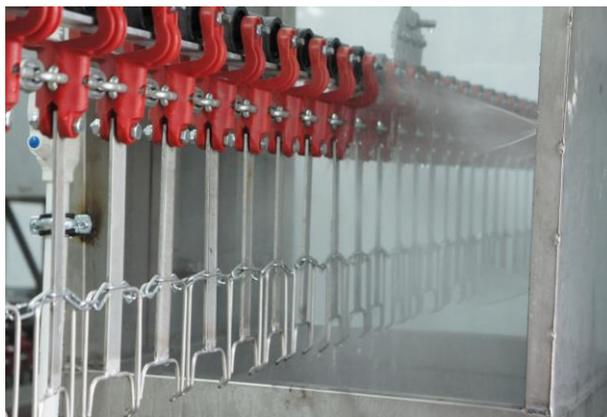
Устройство состоит из: рамы, на которой закреплены поддон и кожух. На раме установлены шторки, форсунки и водопроводный кран.
