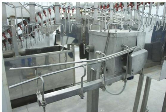
Положение ножа относительно направляющих регулируется с помощью винта. Величина зазора между направляющими регулируется за счет перемещения нижней направляющей в зависимости от диаметра (толщины) шеи перепела. По отношению к машине перепел, висящий на конвейере, расположен грудью к ножу. Шея должна заходить между направляющими.
