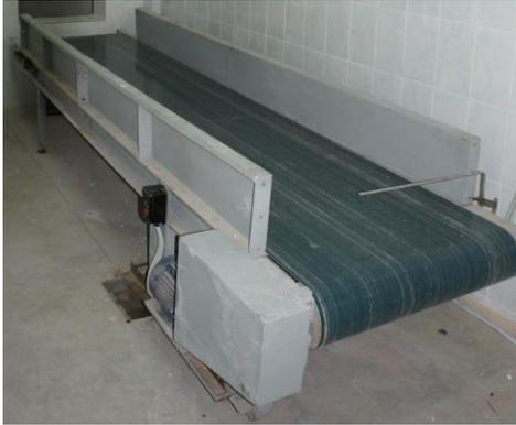
Транспортёр предназначен для транспортировки ящиков с перепелами на участок навешивания.
