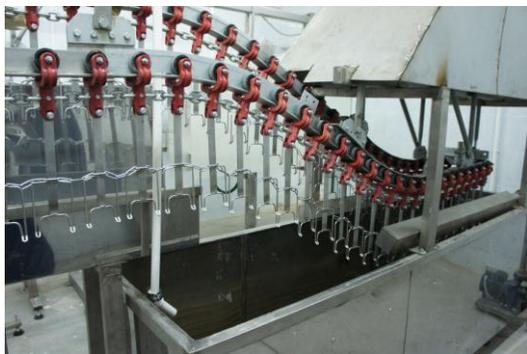
Ванна представляет собой сварную конструкцию, в которую вмонтирован медный трубопровод (теплообменник) для нагрева воды. По бокам ванны установлен трубопровод обеспечивающий каскад падающей воды для смачивания оперения перепелов и лучшего перемешивания воды.
