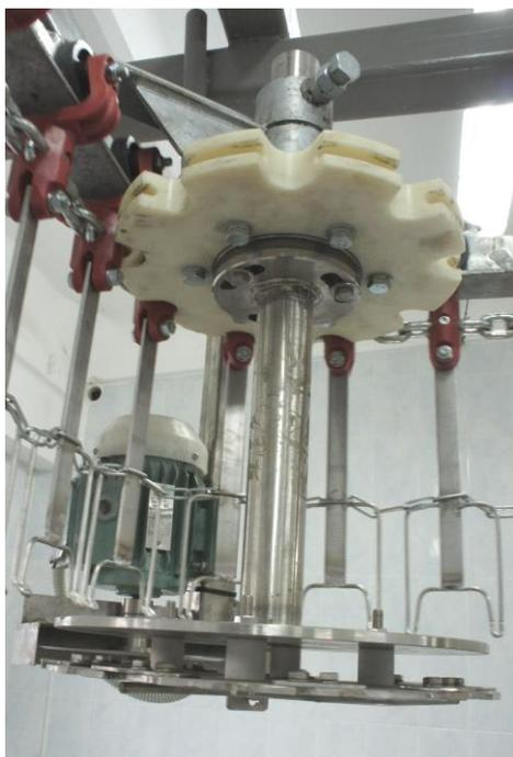
Машина состоит из вала и установленного на нем с помощью болтов через дистанционные втулки фигурного диска, а также перекладины и стойки. Перекладина приварена к каркасу поворотной станции подвесного конвейера. На стойке закреплены: рабочий орган (электродвигатель с насаженным на конец вала дисковым ножом), направляющая и кожух.
