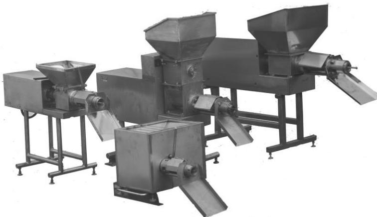
**Прессы предназначены** для механизации обвалки (отделения мяса от кости) тушек или частей всех видов птицы и рыбы
