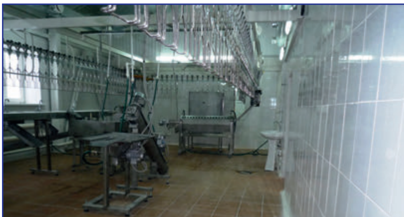
Рис. 3. Загрузка ног птицы в машину очистки непосредственно с конвейера
