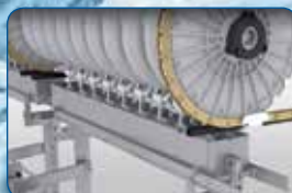
Весовой механизм «над потоком» 3
