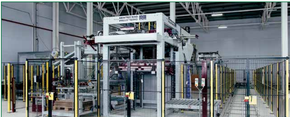
Роботизированная линия упаковки готовой продукции
