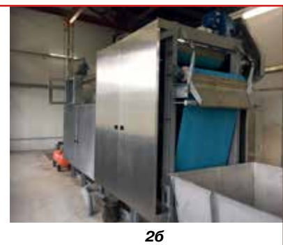
Рис. 2: а) узел механической очистки; б) узел обезвоживания осадков на ленточном фильтр-прессе
