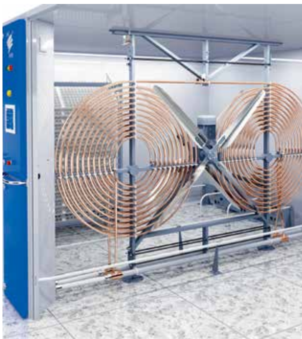
Циркуляционная вентиляционная система промышленного инкубатора ИП-АМС
