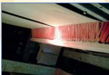
Яичный конвейер. Сейчас большинство яичных конвейеров изготавливаются из пластика и имеют структуру с открытыми отверстиями (слева). Это упрощает их очистку. В прошлом использовали джутовые конвейеры (справа), но они быстро загрязнялись, и их было трудно очищать.
