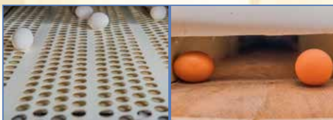
Яичный конвейер. Сейчас большинство яичных конвейеров изготавливаются из пластика и имеют структуру с открытыми отверстиями (слева). Это упрощает их очистку. В прошлом использовали джутовые конвейеры (справа), но они быстро загрязнялись, и их было трудно очищать.
