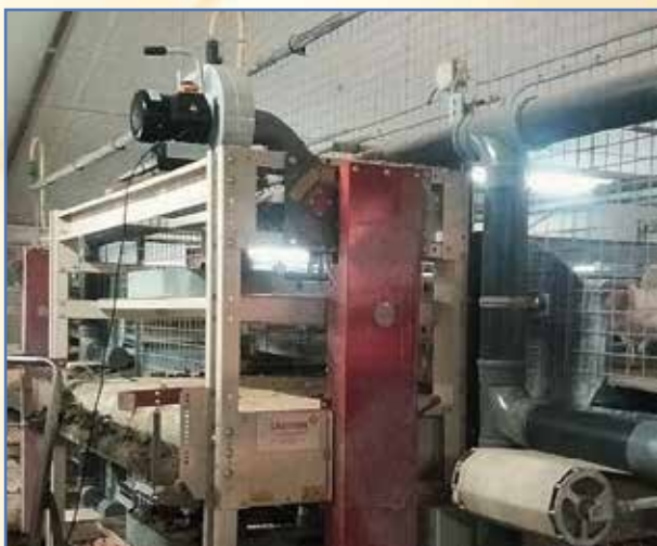
Этот фермер установил вакуумное очищающее устройство над яичным конвейером в целях удаления пыли и перьев.
