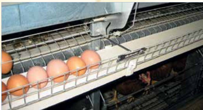
Распределитель яиц. Основная функция распределителя яиц — не дать им ударяться друг о друга. Помимо этого, он увеличивает время обсухания яиц.
