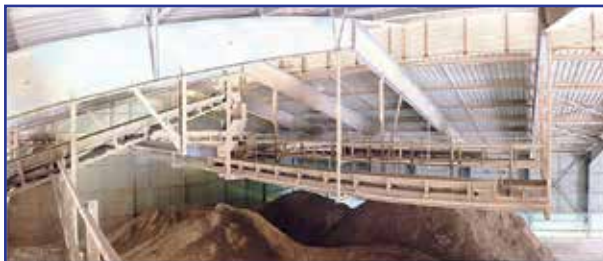
Рис. 5. Продольное распределительное устройство с тремя транспортными лентами
