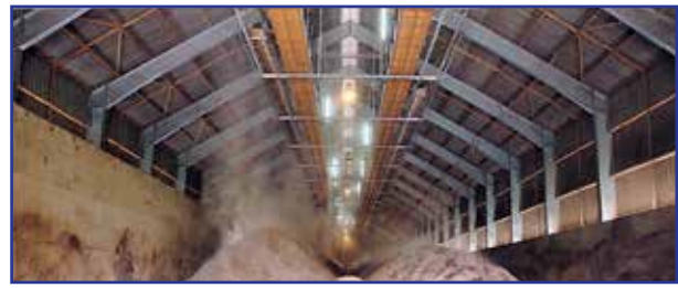
Рис. 6. Продольное распределительное устройство с двумя транспортными лентами
