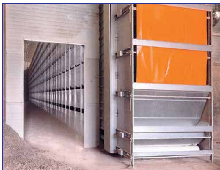
Рис. 2. Установка для сушки помета туннельного типа OptiSec с 16 ярусами
