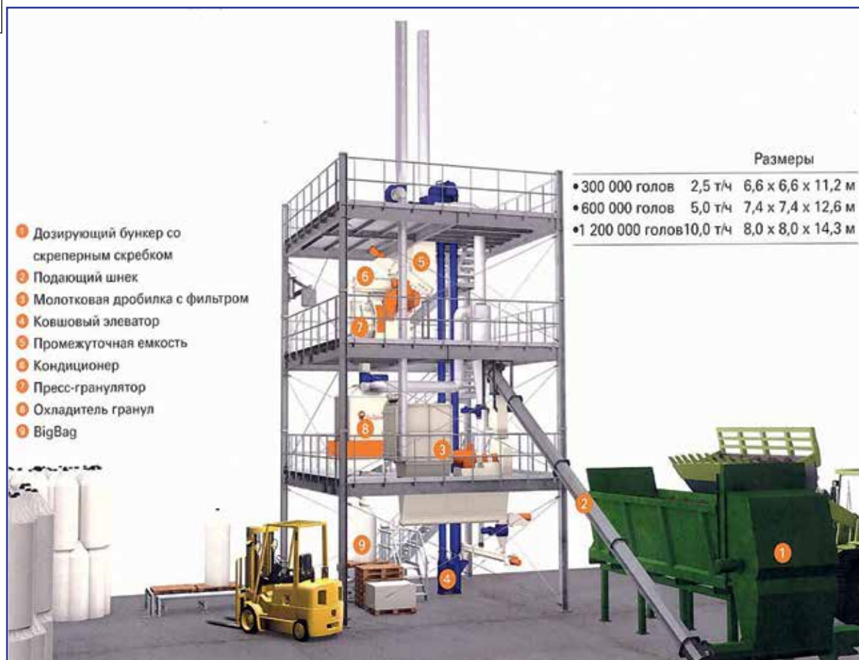
Рис. 8. Конструкция и принцип работы BD PelletTower
