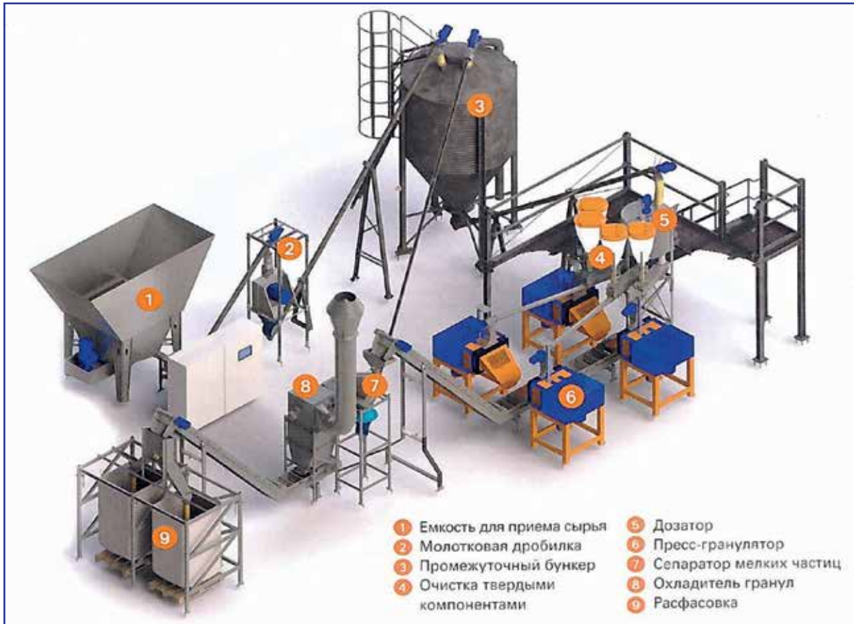
Рис. 7. Конструкция и принцип работы BD PelletFix
