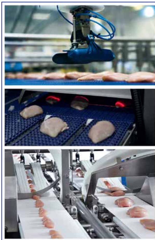
Роботизированный нож позволяет максимизировать использование продукта и сократить потери
