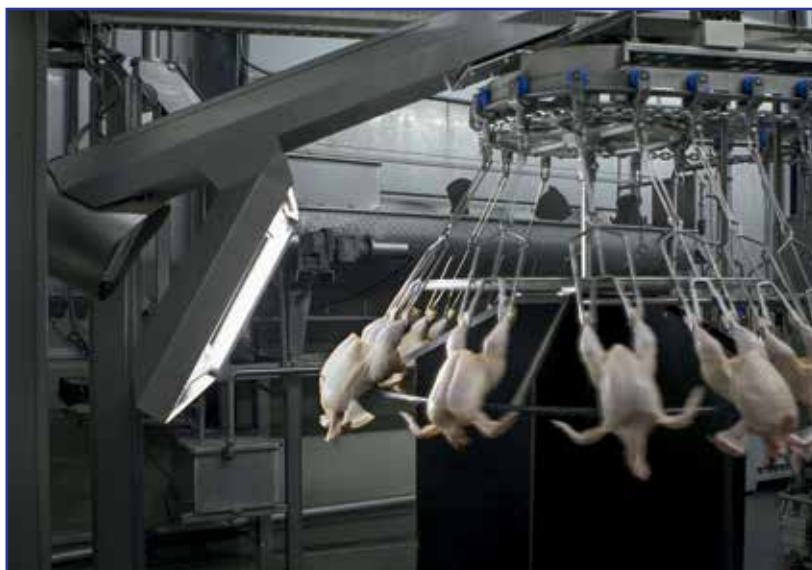
Система визуального контроля позволяет провести раннюю классификацию продуктов, обеспечивая высокий уровень пищевой безопасности
