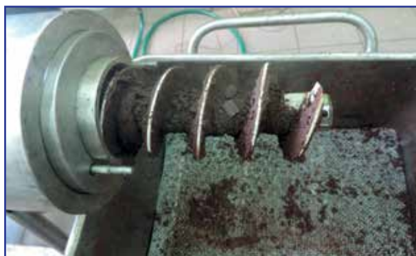
Рис. 3. Полипропиленовый шнек перед санитарной обработкой
