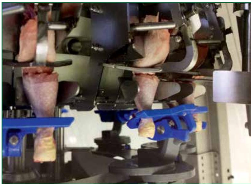
Узел линии обвалки фирмы *Marel*
