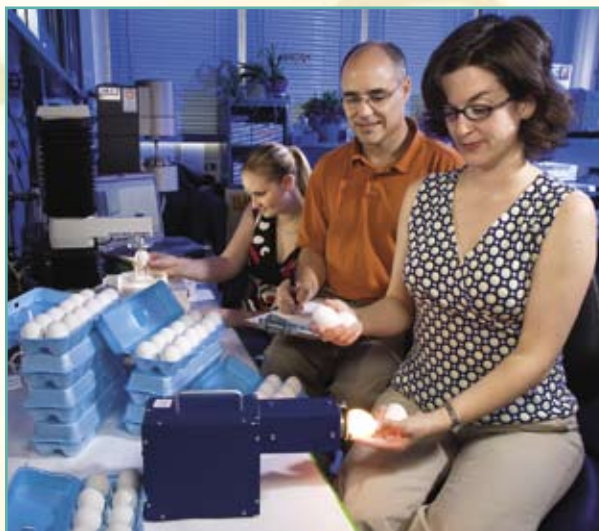
Фото 4. Технолог-пищевик Диана Джоунз (на переднем плане) и специалист по гиперспектральному воспроизведению образов Джерри Хайтшмидт проверяют яйца на наличие дефектов скорлупы, а ассистент Вики Бруссар использует прибор давления для проверки яиц на трещины
