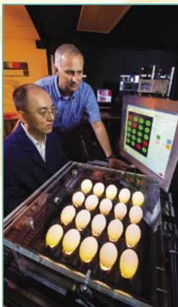
Фото 1. Исследователи из ARS разработали инструмент, который освещает яйца и использует систему образов, чтобы в постоянном режиме отслеживать наличие трещин на яичной скорлупе, какими бы тонкими они не были. Инженер-электрик Сеунг Чул Юн (слева) и агроинженер Курт Лоренс исследуют результат работы системы
