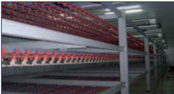
Рис. 1. Фрагмент силовой рамы для линии воздушно-капельного охлаждения
