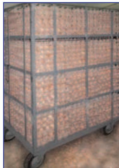
**Рис. 2. Четырехъярусная тележка для транспортировки инкубационных яиц**
