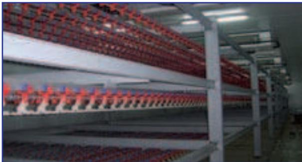
**Рис. 1.** Фрагмент силовой рамы для линии воздушно-капельного охлаждения
