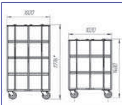
**Рис. 1. Тележка для перевозки инкубационных яиц: а) для транспортировки на дальние расстояния; б) для транспортировки на ближние расстояния**
