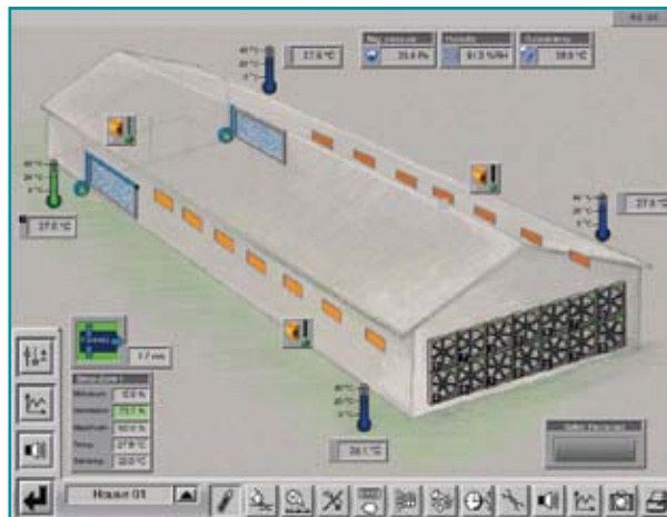
Рис. 2. Система управления птичником Atacs 2.0
