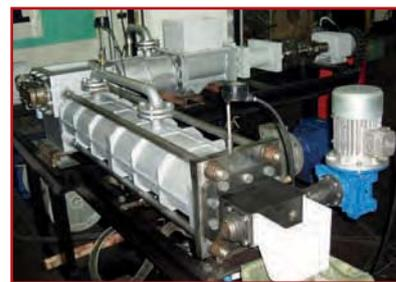
**Рис. Серийный образец гидролизера для высокотемпературной кратковременной обработки (производительность 500 кг влажного пера/ч или 250 кг сухого пера/ч)**
