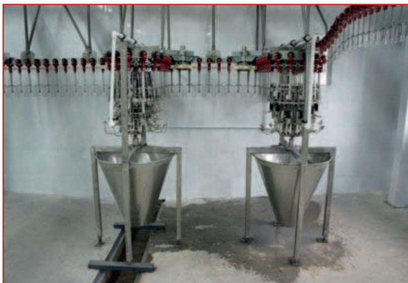
Рис. 8. Вскрыватель и потрошитель тушек
