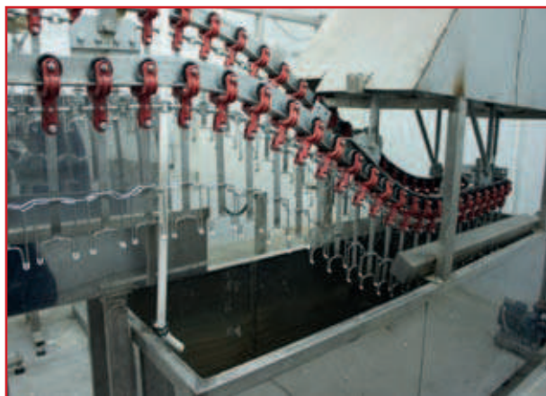
Рис. 6. Ванна тепловой обработки
