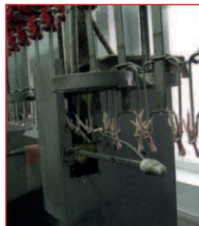
Рис. 10. Сбрасыватель отрезанных ног
