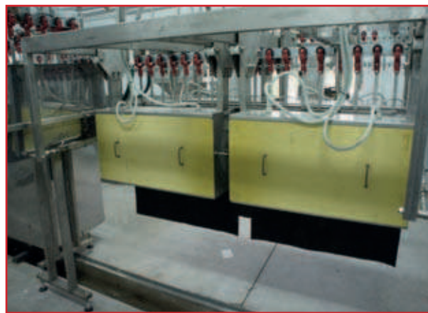
Рис. 7. Машина снятия оперения
