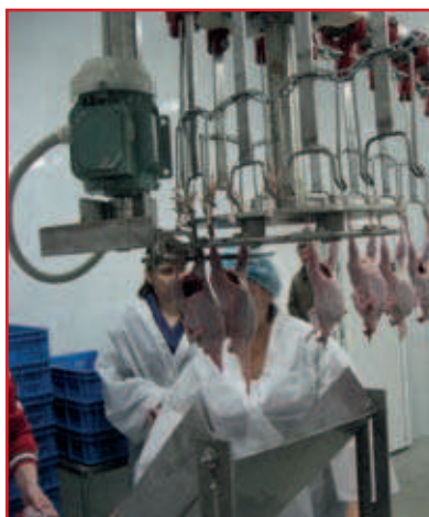
Рис. 9. Машина отрезания ног
