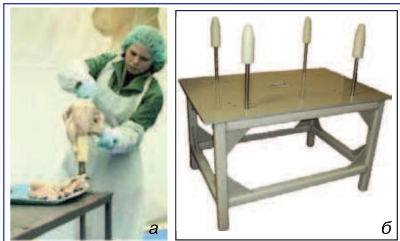
**Рис. 1. Оборудование для разделки тушек птицы и выделения филе на предприятиях малой мощности (до 2,0 т/смену)**
