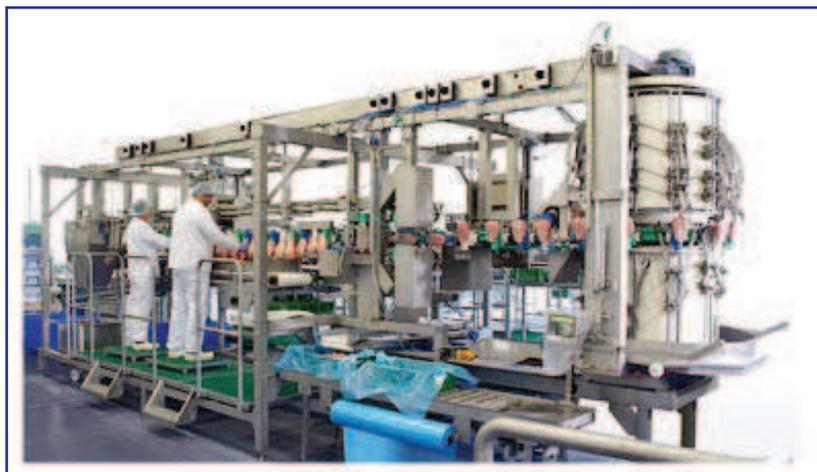
**Рис. 7. Автоматическая филетировочная машина Meyn Rapid HQ**
