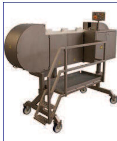
Рис. 6. Филетировочная машина ротационного типа фирмы *Food Mate*
