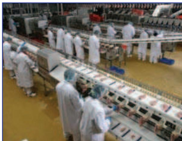
**Рис. 3. Полуавтоматическая линия филетирования фирмы *Stork PMT B.V.* (Нидерланды)**
