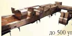
На стенде *Diamond Moba* доминировала система *Moba Omnia FT Grader* мощностью от 85 до 500 упаковок в час. Как утверждают специалисты компании, здесь практически исключена возможность столкновения яиц во время движения по конвейеру. Это достигается за счет добавления новых треков и подачи строк по сравнению с конкурентами и улучшения конфигурации конвейера. Контакты между яйцами ограничены, что, естественно, уменьшает бой.
