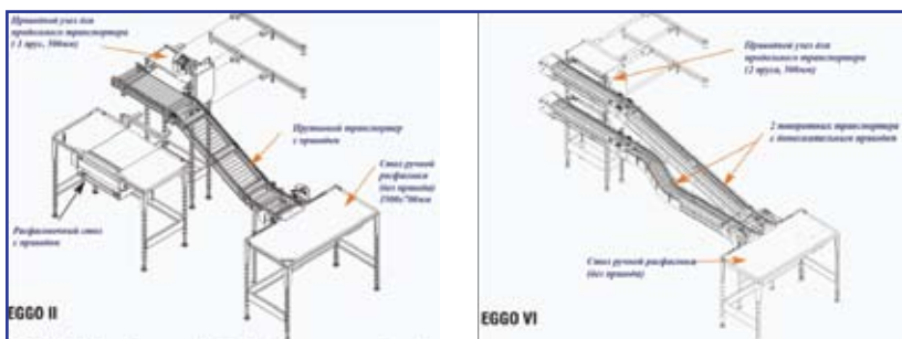
Рис. 4. EGGO — компактные узлы для сбора яиц с двухъярусных двойных гнезд
