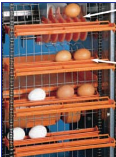
Рис. 3. Двухкомпонентная шестерня дозатора позволяет предотвратить появление насечки на яйцах
