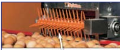
Рис. 2. Переход яйца на поперечный транспортер при помощи колеса с пальчиковой передачей
